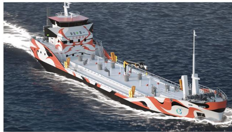
株式会社e5ラボが導入するCorvus Energy社製ESS搭載予定の完全電動内航タンカー
